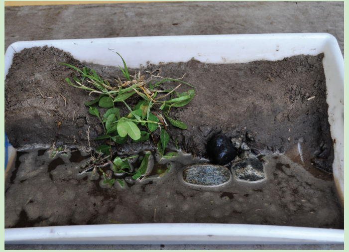
Imagem 12 - Ao final será possível perceber que as características das praias respondem de formas diferentes a energias de ondas. E principalmente que a praia sem proteção sofreu mais erosão e as ondas alcançaram uma distância maior (sentido costa).
